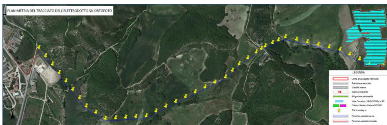
Figura 2 - Cavidotto MT (in rosso scuro cavidotto interrato, in blu nuovo cavidotto aereo)
